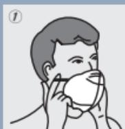
1 Die Maske an den Ohrenschlaufen (Nasenclip oben) gegen das Kinn ansetzen und über die Nase ziehen.
